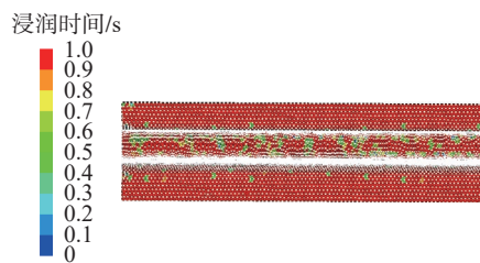
(c) 树脂膜在上时加强筋表面树脂流动过程
